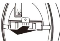
カバーをはずして光触媒フィルターを取りはずす
